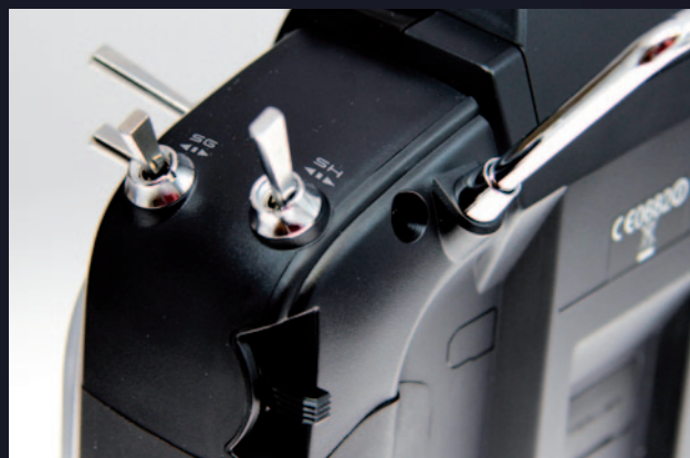
2 Seitliche Drehgeber zur Bedienung ohne Loslassen der Steuerknüppel
